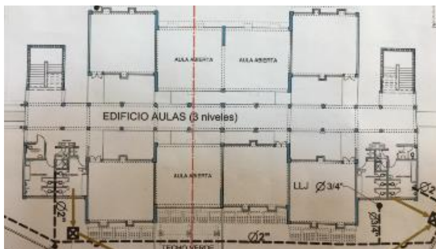
Foto 16. Escuela en construcción Juan Bosch 1 con irregularidad en planta
