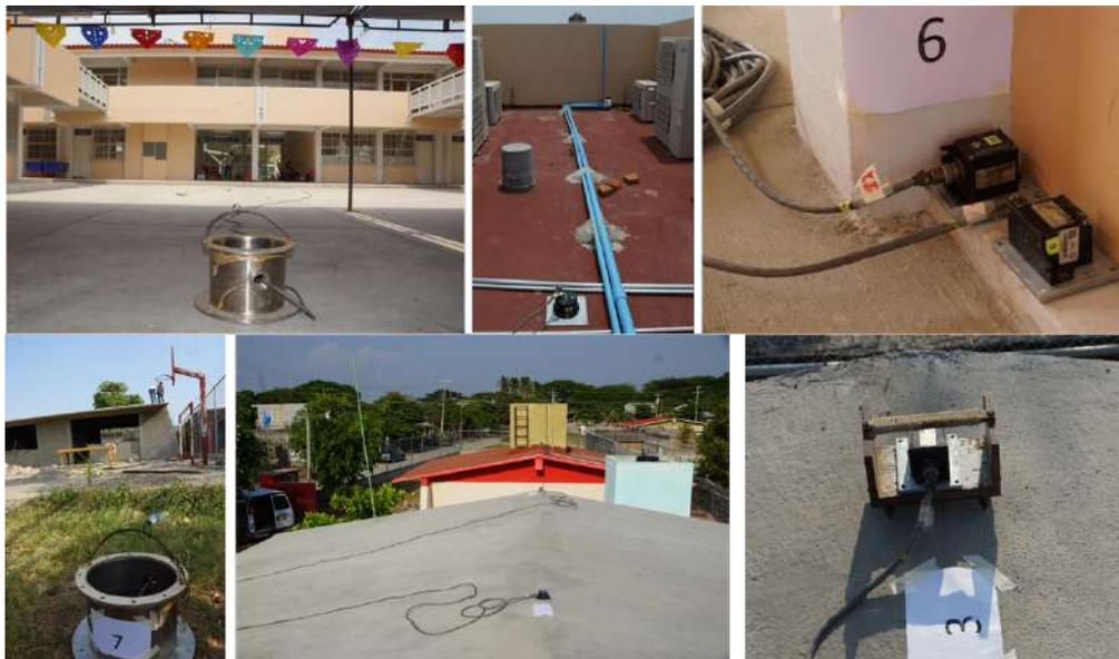
**Figura 5.74** Vista de puntos instrumentados con acelerómetro en las escuelas “Centro Escolar Juchitán” y Telesecundaria
