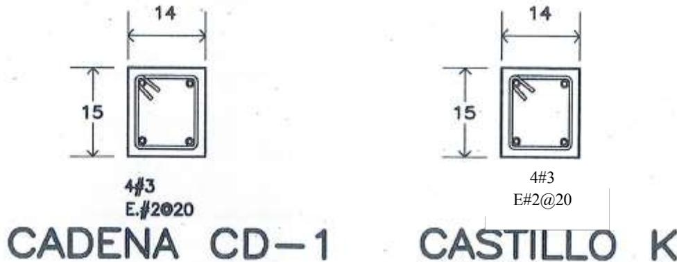
*Figura 7.8 – Detalle de armado de castillos de la fig. 7.7 (INIFED, 2017)*
