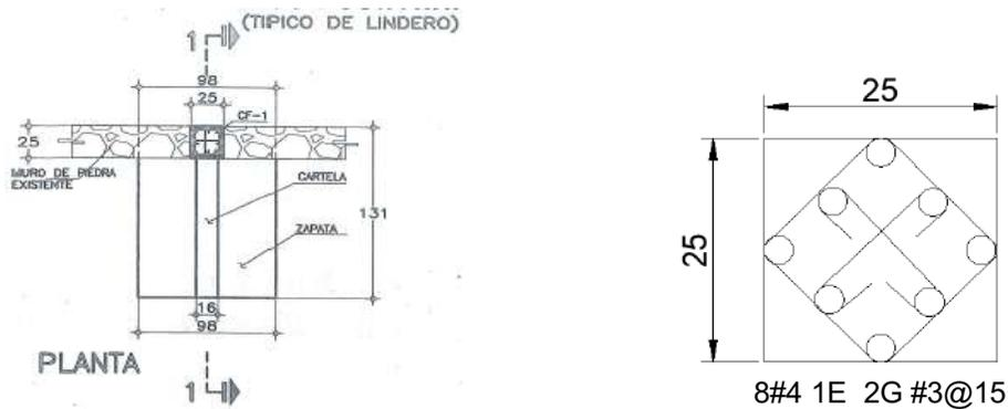
Figura 7.12 – Armado de contrafuerte de bardas (INIFED, 2017)
